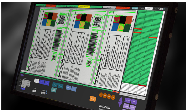
図4：Baldwin Vision Systems製品などの印刷検査システムは、欠陥をすべて排除して、ブランドオーナーに完璧な画質を提供します。
